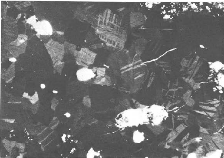
Abb. 22: Panzendorf (Osttirol). Ausschnitt aus körnigem Rekristallinat von vorherrschend Kupferkies, etwas Magnetkies (durch Anisotropie-Effekte stark aufgehell – weiß) und wenig Gangart (durch Innenreflexe stark aufgehell – weiß). Kupferkies hat sogar in den körnigen Rekristallisaten die typischen oleanderblatt- bis lanzettförmigen Umwandlungslamellen von Hochtemperatur-Kupferkies ausgebildet. Anschliff, Vergr.: 115 \times , Polarisatoren +
