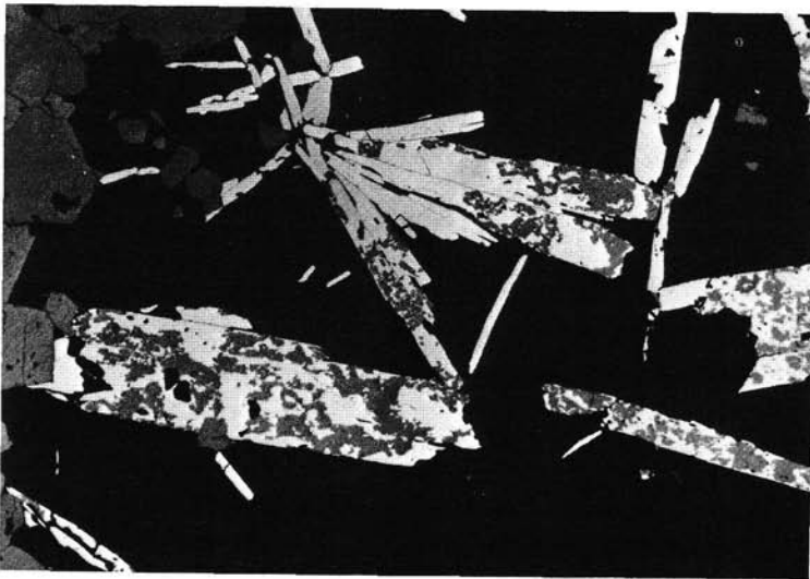
Abb. 2: Fröschnitzgraben/Semmering (Steiermark). Idioblastischer Magnetit (dunkelgrau) und idioblastischer Eisenglanz (lichtgrau) in sideritischem Karbonat (schwarz). Die tafeligen Hämatit-Kristalle werden deutlich von Magnetit verdrängt und pseudomorphosiert („Muschketoffit“). Anschliff, Ölimmersion, Vergr.: 40 \times .
